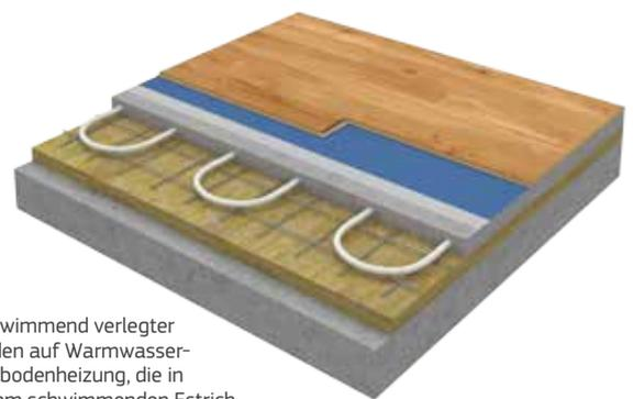
Schwimmend verlegter Boden auf Warmwasser-Fußbodenheizung, die in einem schwimmenden Estrich integriert ist
