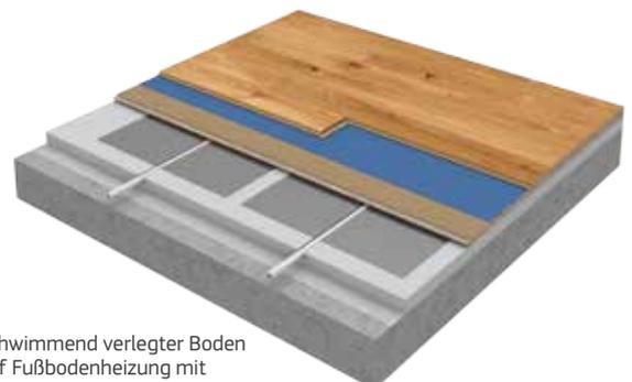
Schwimmend verlegter Boden auf Fußbodenheizung mit Heizschlaufen in Wärmeleitplatten
